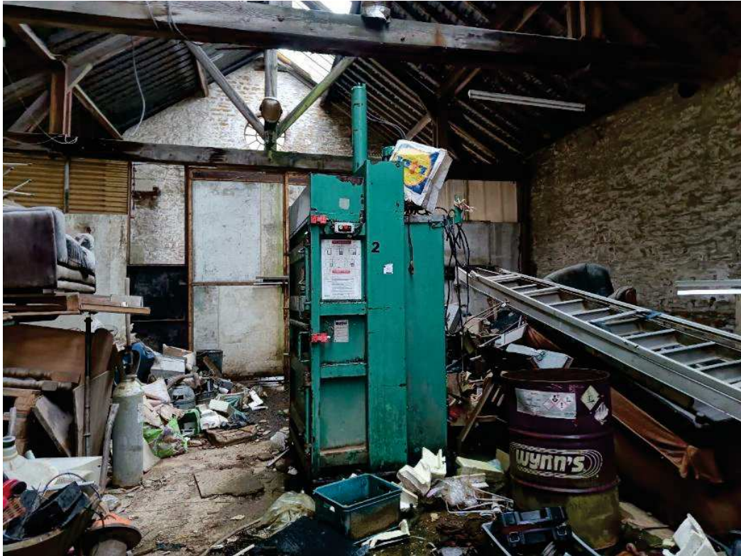
Figure 22 : Compacteuse de plastiques
