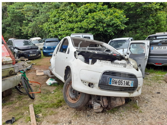
VHU sur sol non imperméabilisé
