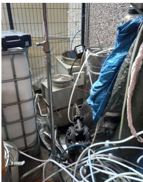
D) Exemples de déchets/tests de laboratoire dans la conception de e-liquide, de liquides non-identifiés et de déchets potentiellement dangereux stockés en extérieur, exposé aux éléments sans protection appropriée et sans mise sous rétention
