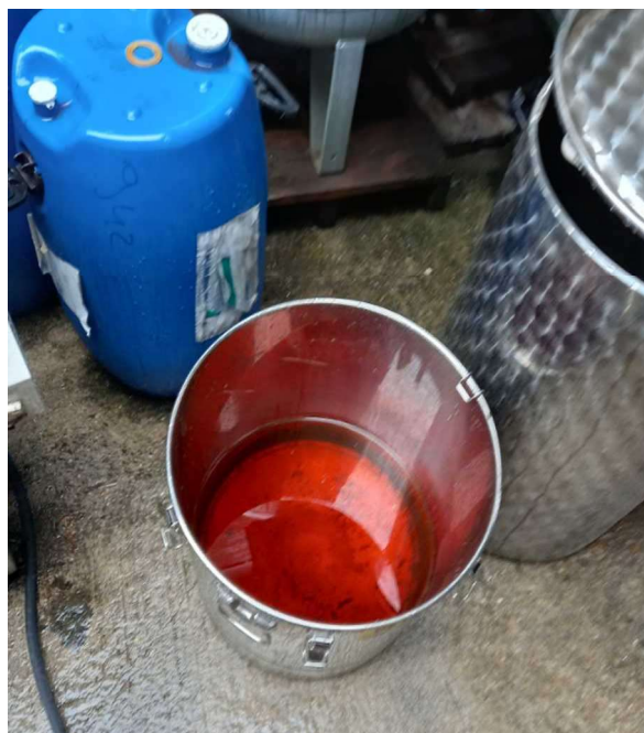
D) Exemples de déchets/tests de laboratoire dans la conception de e-liquide, de liquides non-identifiés et de déchets potentiellement dangereux stockés en extérieur, exposé aux éléments sans protection appropriée et sans mise sous rétention
