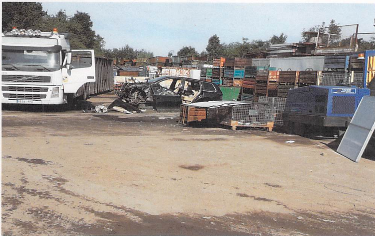
Vue prise non loin de l'entrée du site – En partie centrale, VHU en cours de démontage, nombreuses traces d'égouttures de fluides constatées le 23/06/2023
