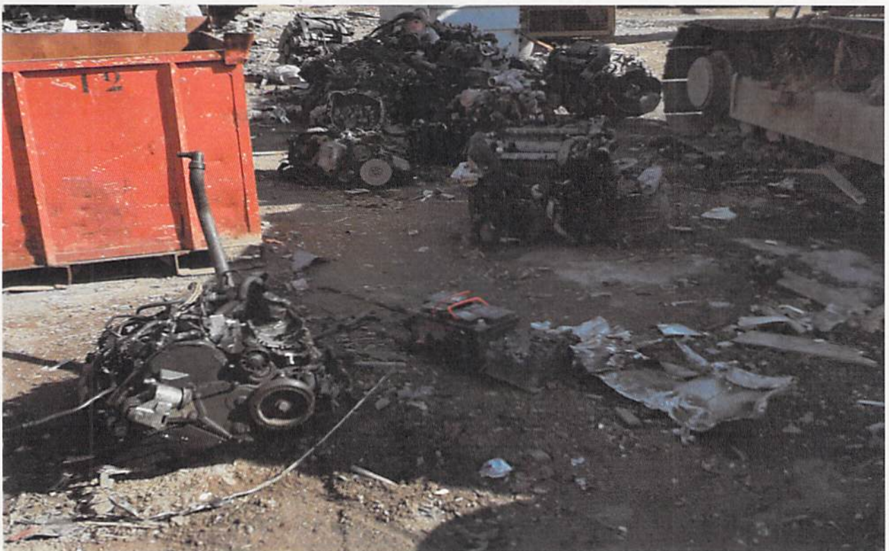
Moteurs issus du démontage de véhicules, batteries usagées entreposés à même le sol non imperméabilisé (avec nombreuses traces d'égouttures)
