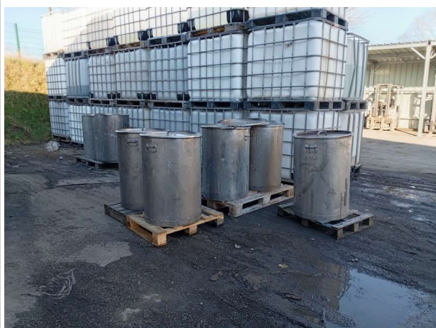
Stockage sans rétention de cuves contenant des résidus de produits dangereux sur un sol laissé nu
