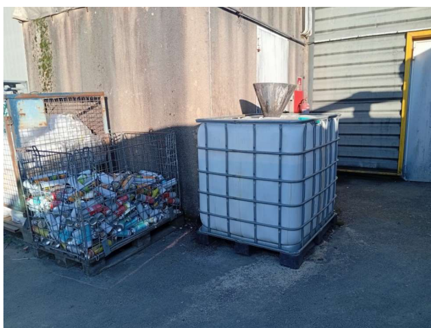
Stockage sans rétention d'un grand récipient vrac contenant des déchets dangereux liquides issus de la fabrication des aérosols
