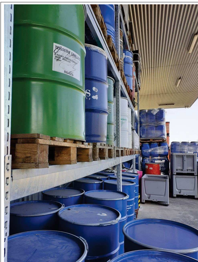
Stockage de déchets sur rack (ayant nécessité les travaux du 15 mai 2023), en contenants étanches et sous auvent
