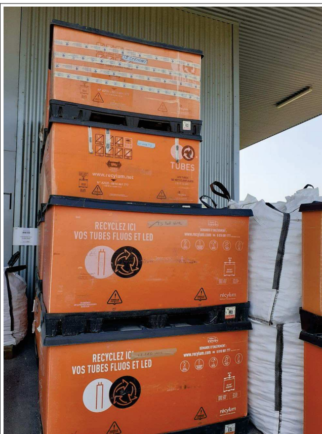
Stockage de déchets sur rack, en contenants étanches et sous auvent
