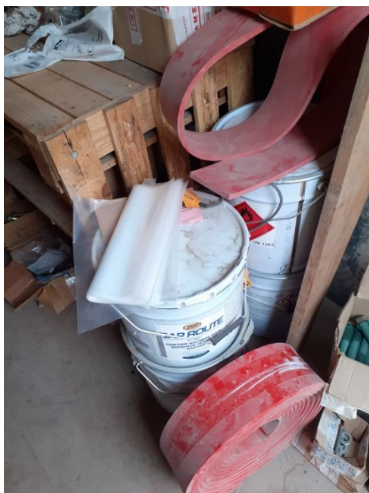
Photo n°3 : peintures inflammables entreposées dans le container faisant office d'atelier avec des matériaux combustibles
