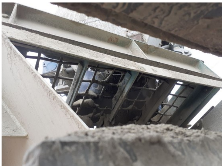
Photo n°1 : bavette souple au niveau de la zone de jetée du crible écrêteur
