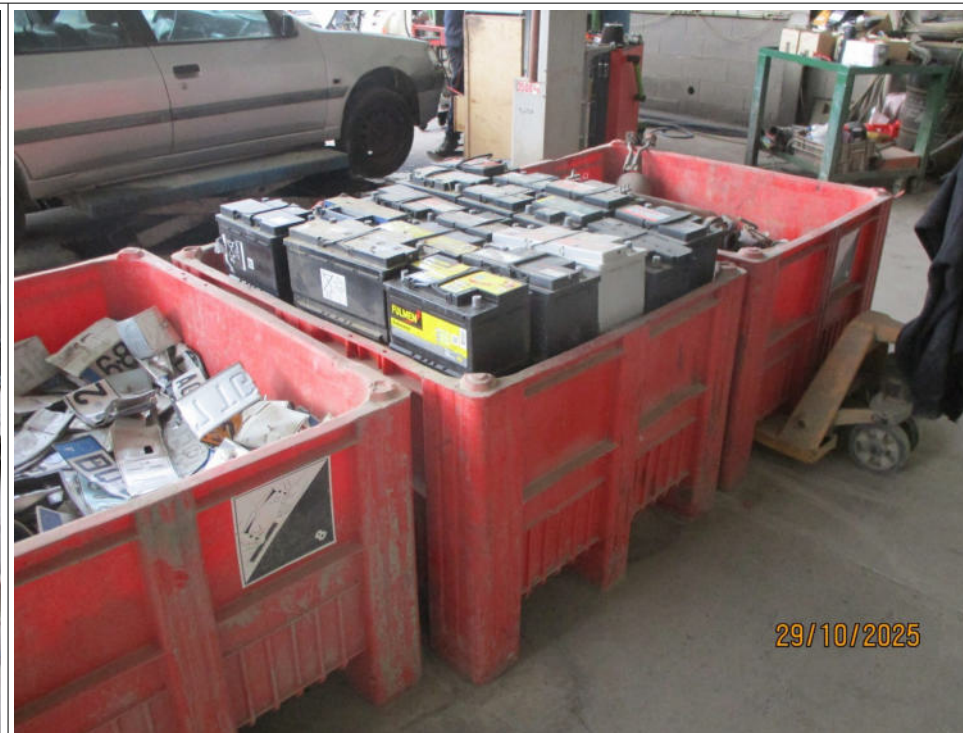
Batteries de démarrage au plomb, retirés des véhicules hors d'usage
