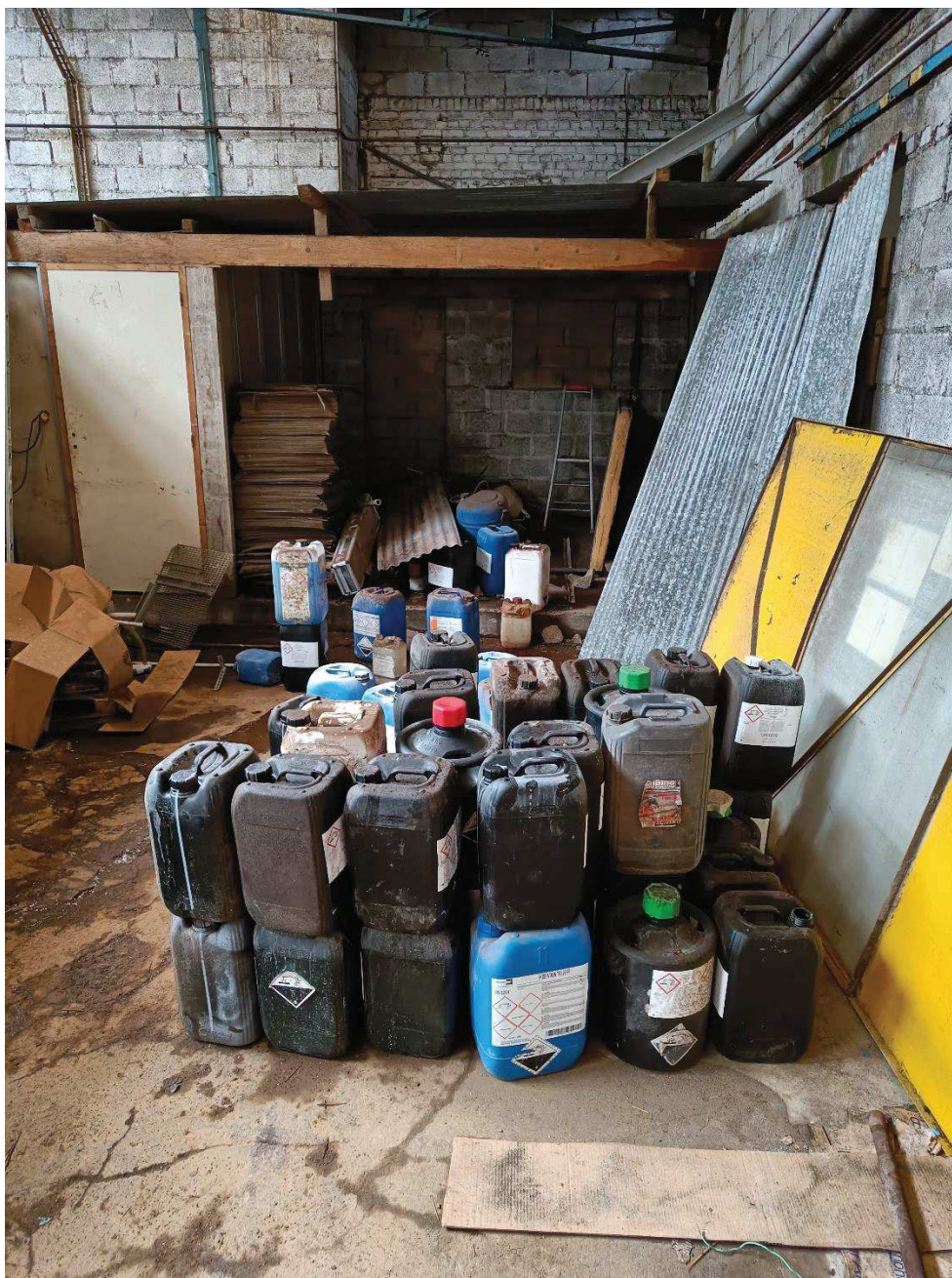
Figure 2 : Emballages vides souillés et bidons pleins sans rétention
