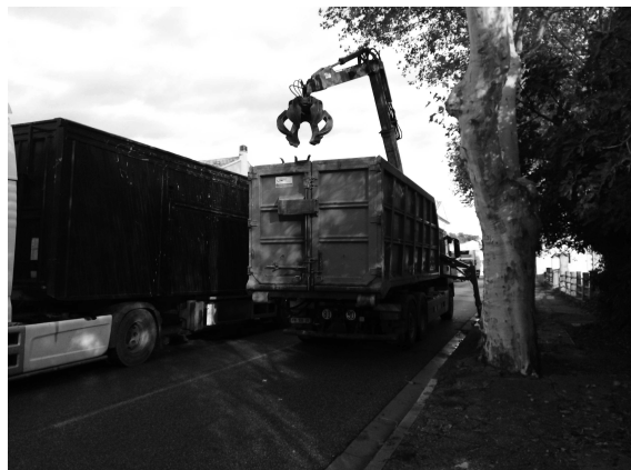
Camion avec bras articulé et grappin permettant la prise des VHU
