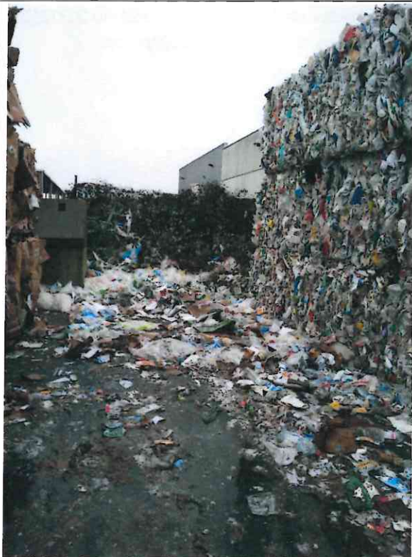
Repère n°11 : Stockage de déchets autres que des ordures ménagères (OM) - Balles de cartons et de plastiques
