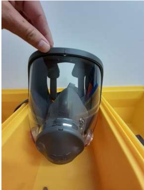
Masque personnel avec filtre à cartouche à disposition des opérateurs
