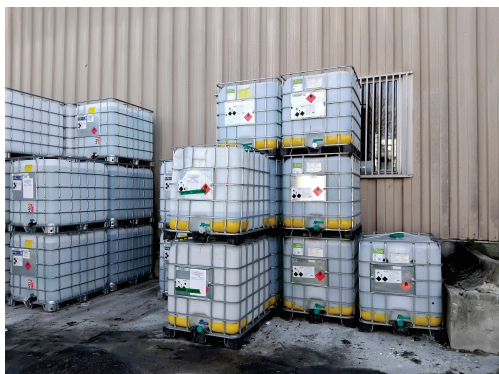
Absence de rétention pour les stockages extérieur
