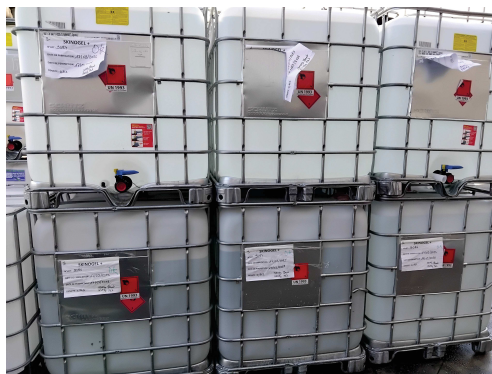
Absence de rétention pour les stockages extérieur
