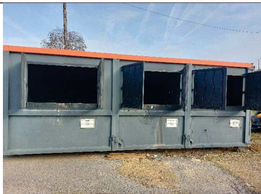
Benne 35 m 3 compartimentée
