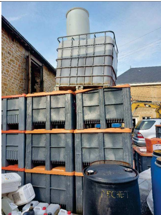
Stockage de 9 containers de déchets dangereux et 6 futs de 200 litres hors rétention
