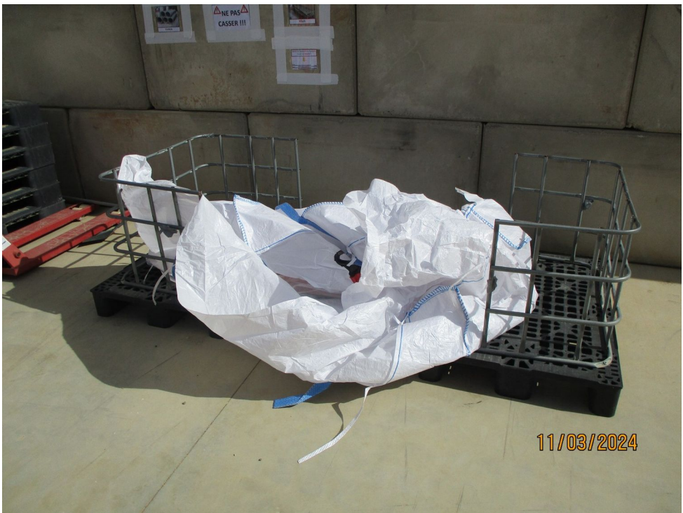
Zone dédiée au dépôt de déchets de MCA pour les particuliers – Photographie du big bag dédié à la collecte de gros éléments de déchets de MCA
