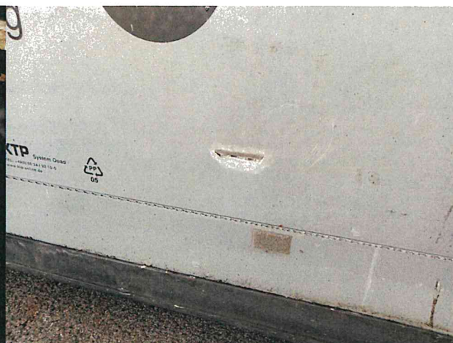
Photo 8 : début de perforation d'une caisse de boues de lavage entreposée à l'extérieur sans retention
