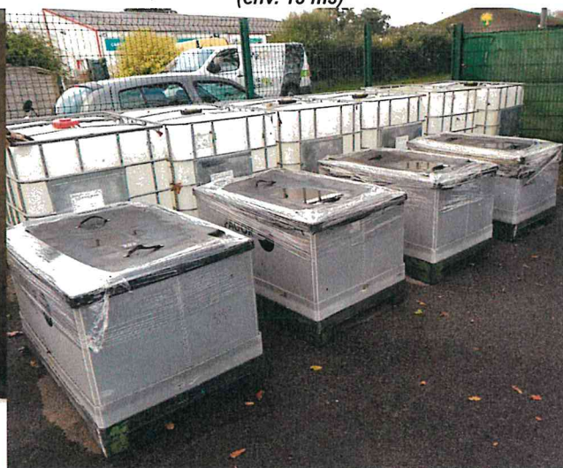
Photo 6 : boues conditionnées en caisses plastiques étanches entreposées à même le sol et sans étiquetage, en attente d'évacuation
