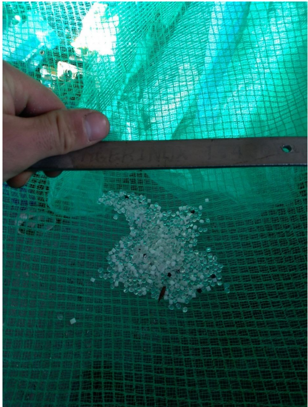
Exemple de panier filtrant mis en place sur un regard de collecte des effluents
