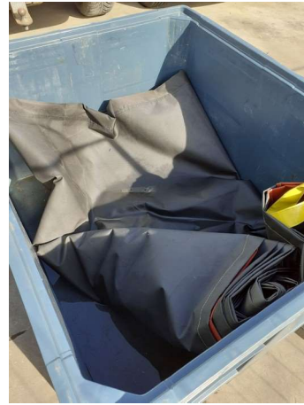
Bâche anti-feu utilisée pour couvrir la batterie en feu dès l'arrivée des services de secours
