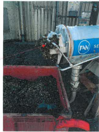
Refiltration du digestat de BT04 via séparateur de phase (FAN) avant envoi vers BT05
