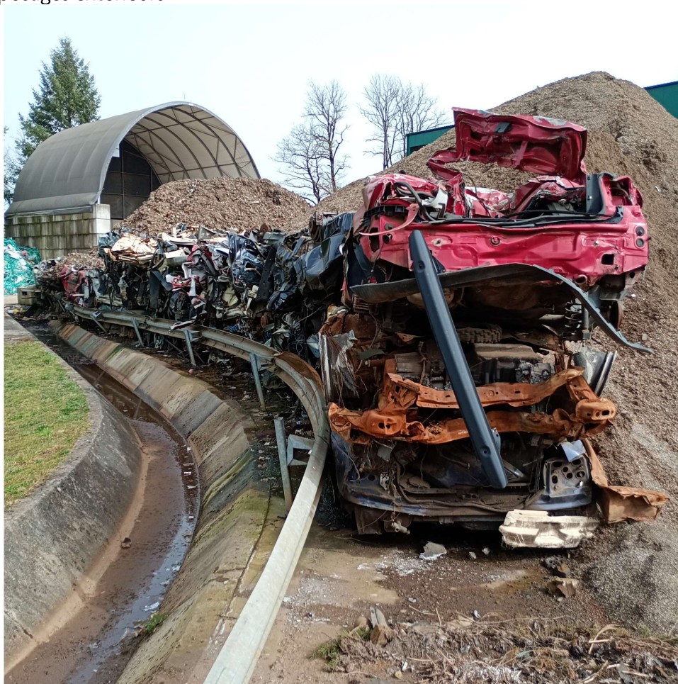
Andain reposant sur châssis VHU
