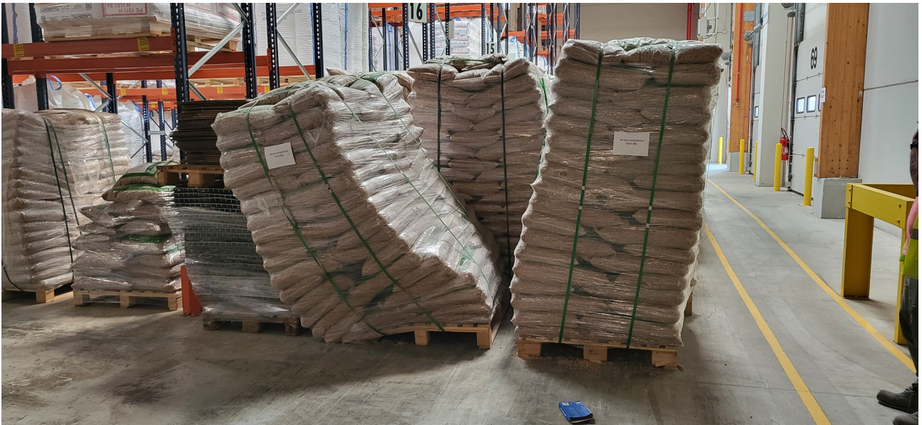
Stockages non conformes dans la cellule n°5
