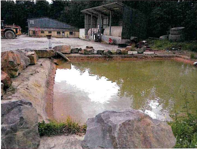
Photo 1 : Eaux d'exhaure traitées prêtes à être réutilisées ou rejetées
