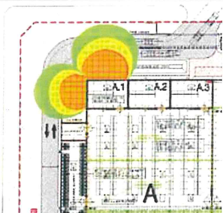
Modélisation des flux thermiques pour la cellule « 1s » (ex-A1), non réalisée sur FLUMILOG
