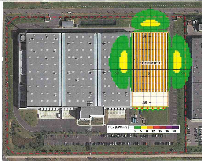
Modélisation des flux thermiques pour la cellule D
