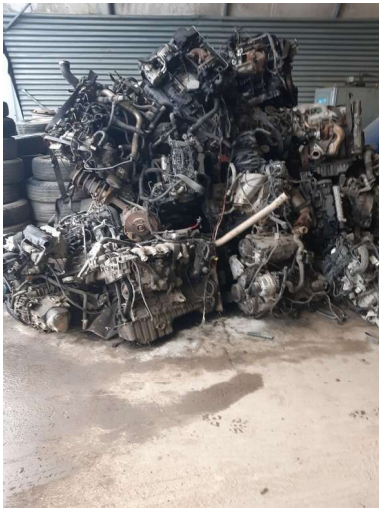
Moteurs extraits des VHU entreposés au sol sans protection
