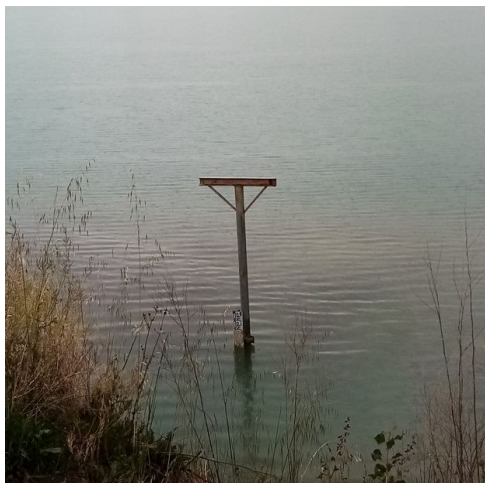
échelle limnimétrique mise en place au niveau du lac n°1
