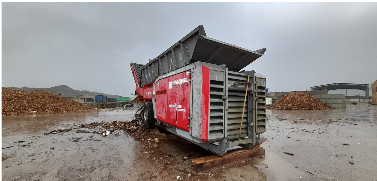
Figure 1: Équipement de broyage de déchets de bois : 175 tonnes par jour
