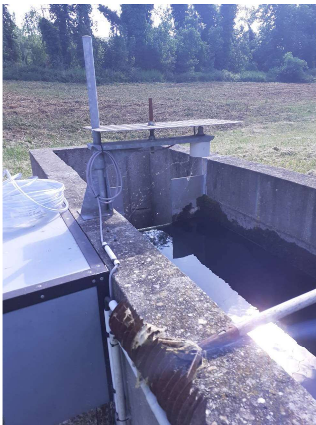
(4) Débit-mètre (type ultrason) et organe de fixation: présence de toiles d'araignées (jour 1)
