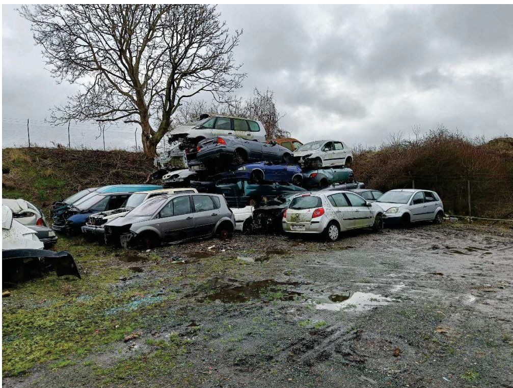
Figure 5 : Véhicules empilés sur une hauteur supérieure à 3 mètres
