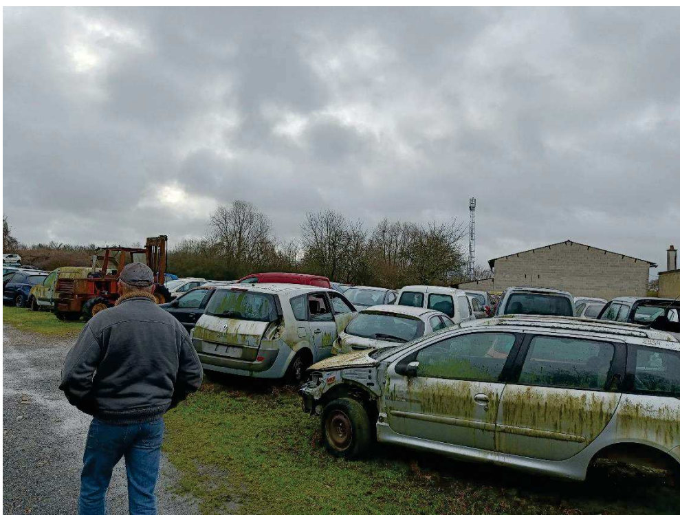
Figure 4 : Zone de stockage de véhicules non étanche (non entièrement dépollués : pneus, sièges, ...)
