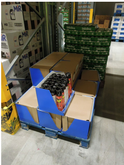
Stockage d'aérosols hors zone aménagée
