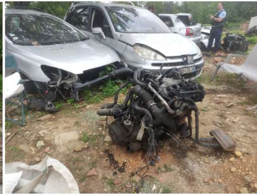
Stockage de VHU et de moteurs sur un sol non étanche
