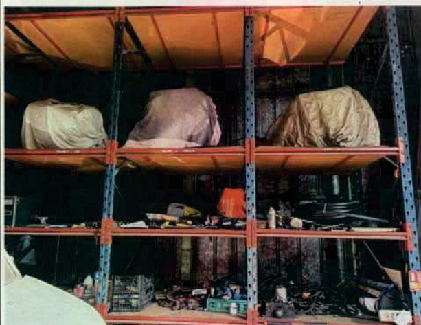
Figure 3: Trois moteurs entreposés sur une étagères sans rétention sous draps
