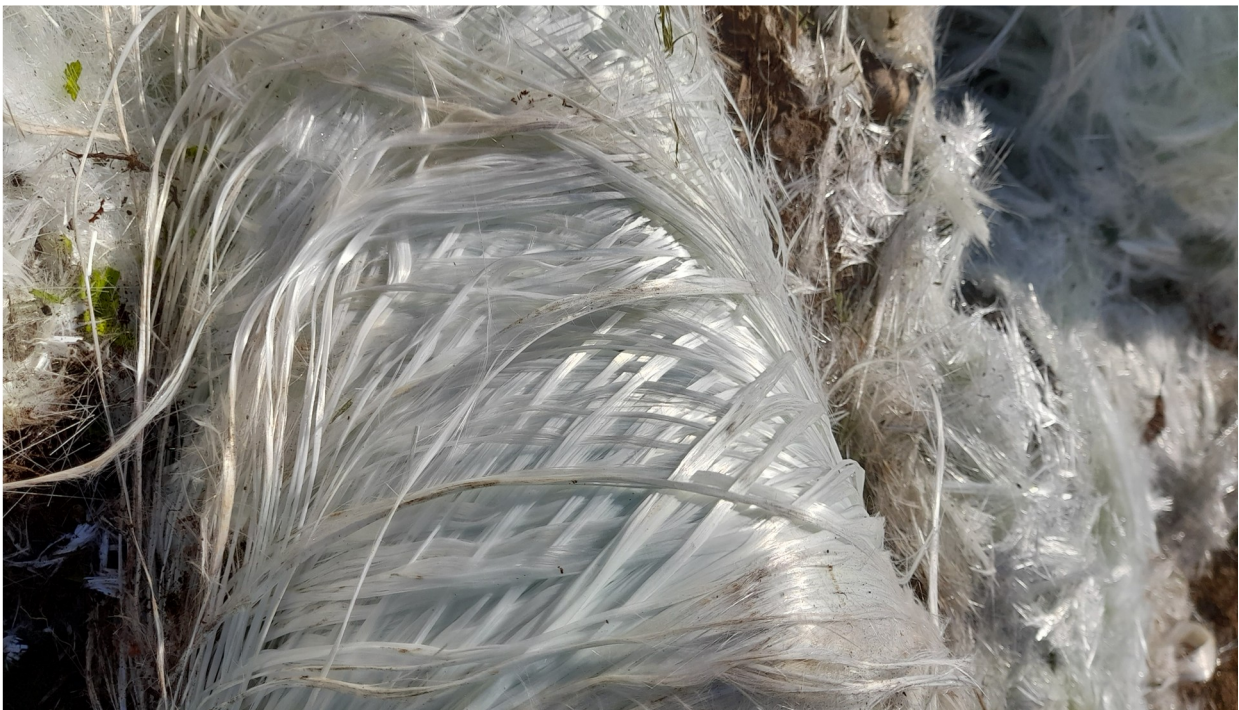
Figure 4: Déchets de fibres de verre sous forme de fibres
