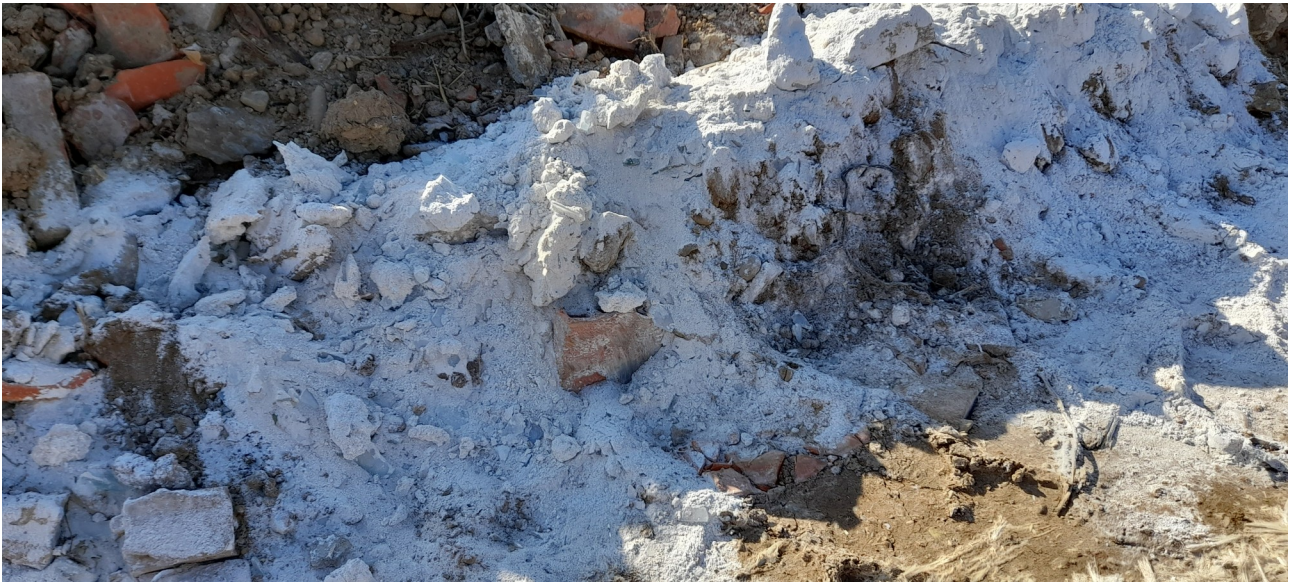
Figure 3: Déchets de fibres de verre sous forme de poudre
