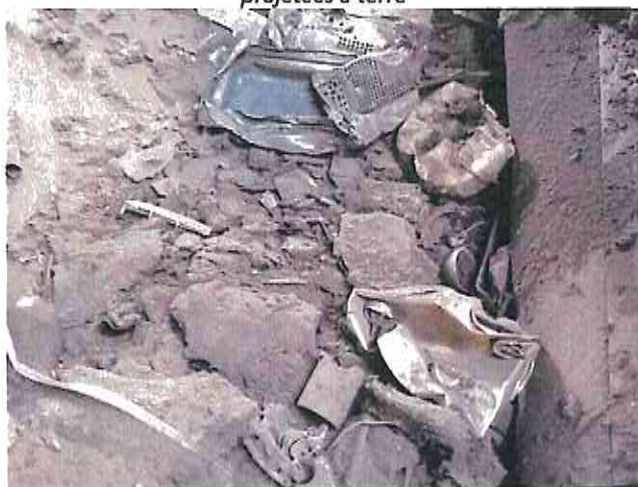
Photo 5 : bris de vitre et résidus de PAM projetés au sol lors de l'explosion
