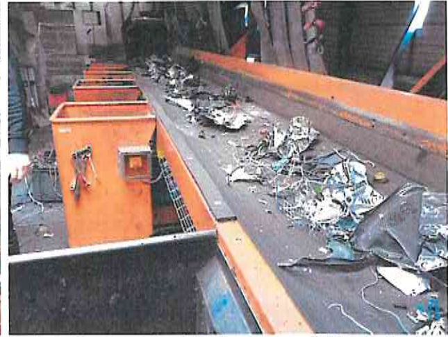
Photo 14 : postes de tri des fragments métalliques triés par l'overband en sortie de QZ
