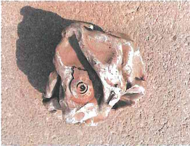
Photo 11 : bouteille de gaz "compactée" mais non "éventrée" retrouvée dans le QZ après l'explosion
