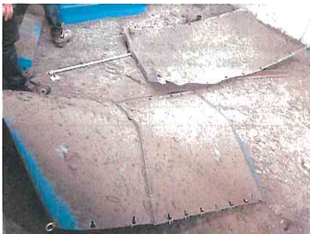
Photo 3 : tôles du capotage de la sortie du QZ froissées et projetées à terre
