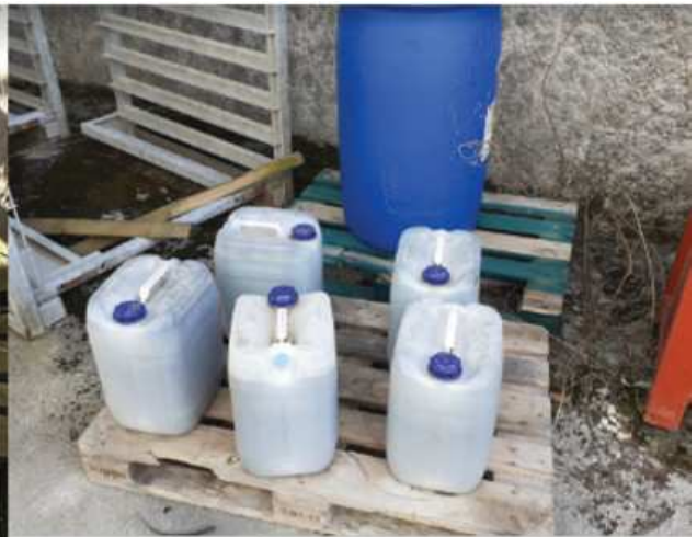
Stockage de produits chimiques sans rétentions et sans identification
