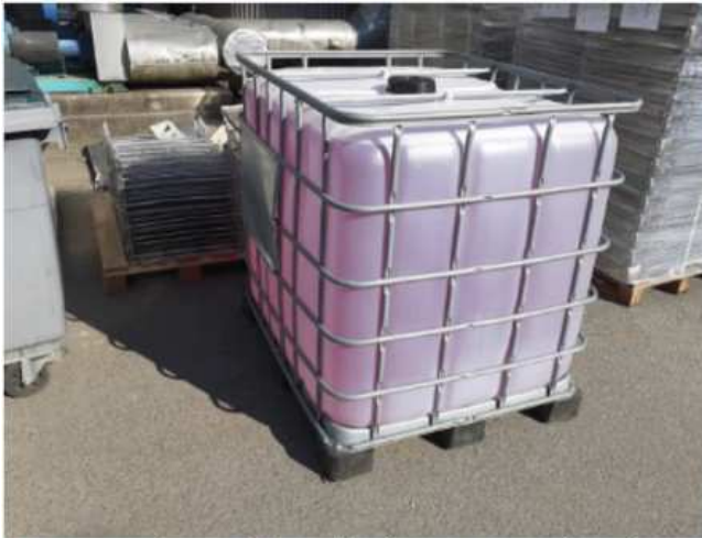
Stockage de produits chimiques sans rétention et sans identification
