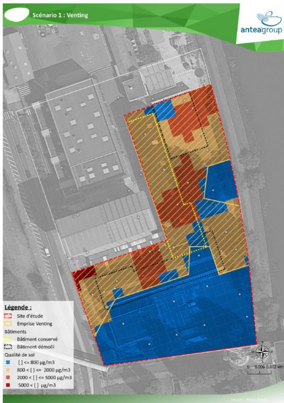
Figure 29 : Scénario 1 - zone à traiter par venting
