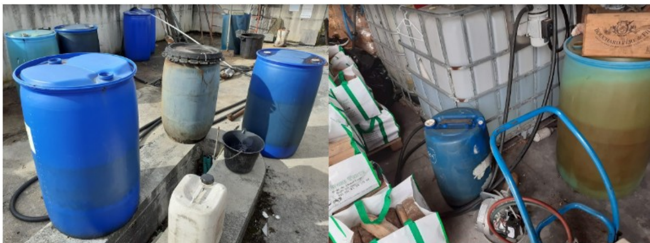
Absence de rétentions et d'identification des fûts et contenants de produits (et propreté générale).
