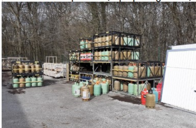
Défaut de rangement des bouteilles de gaz et identification des zones à risques absente. Présence de matériel non lié à l'installation (à droite).
