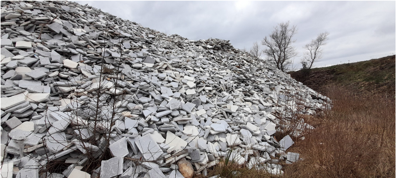
Figure 3: déchets constitués de rebuts de fabrication de pièces en béton.
