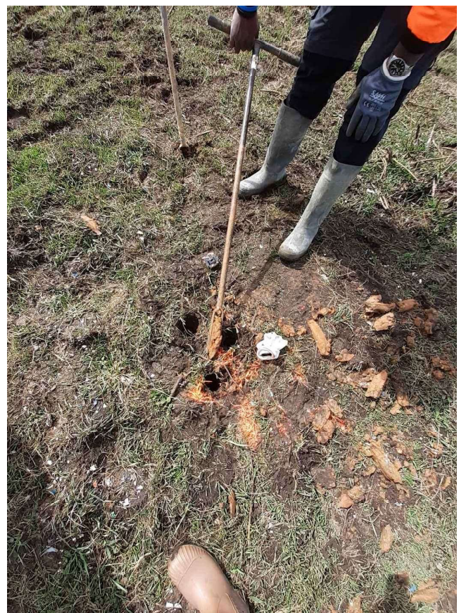
Illustration 3 : terre argileuse en bout de tarière, à 1,10 m de profondeur, au point d'investigation T6
