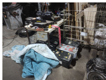
Stockage de batteries sans rétention associée
