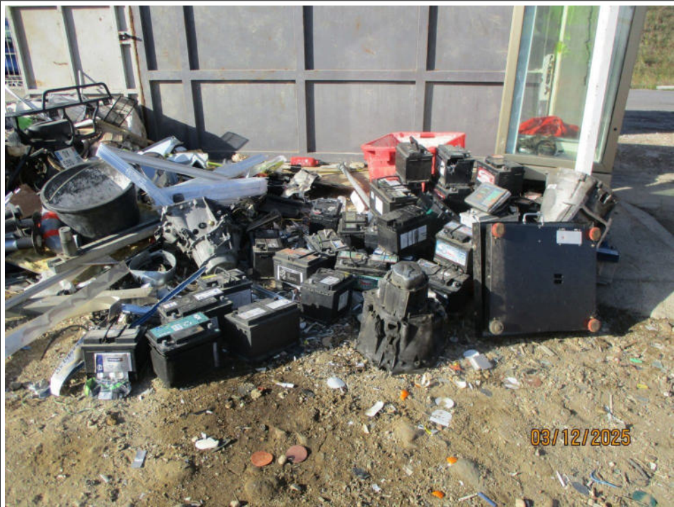
Batteries usagées au plomb déposées à même un sol non revêtu
