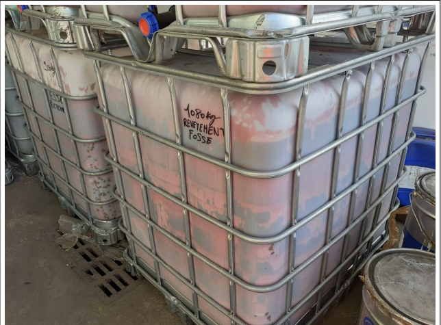
Eaux d'extinction stockées sur rétention
