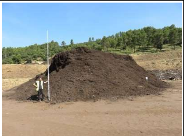
Contrôle de la hauteur avec la règle télescopique (hmax=5m)
