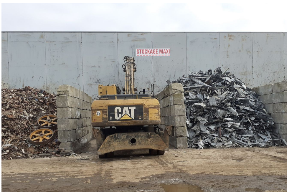
Marquage de la hauteur maximale de la zone de stockage de déchets métalliques
