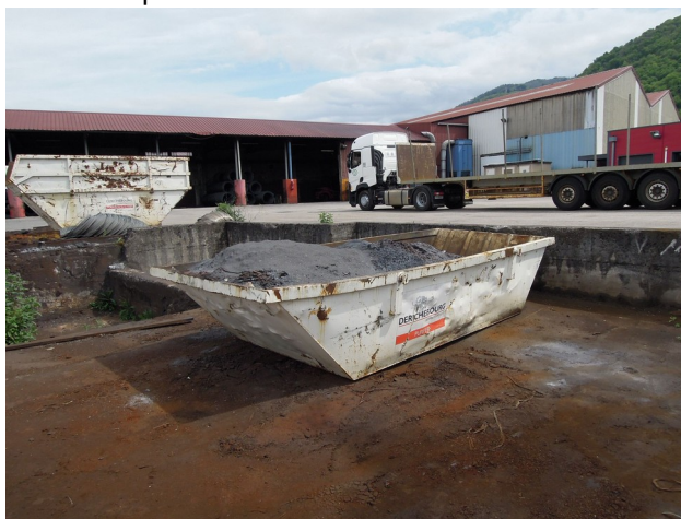
Benne non couverte de déchets de poussières de calamine
