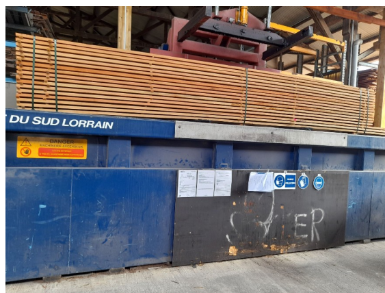
Bac de traitement
