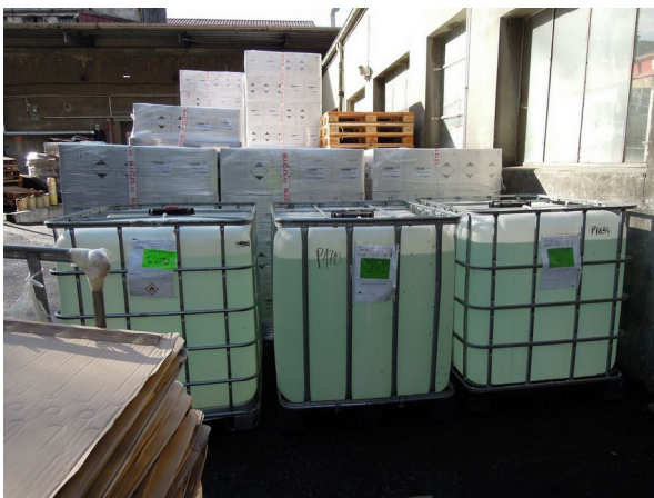
Photo prise le 29/01/2025 de 3 GRV de produits chimiques sans rétention
