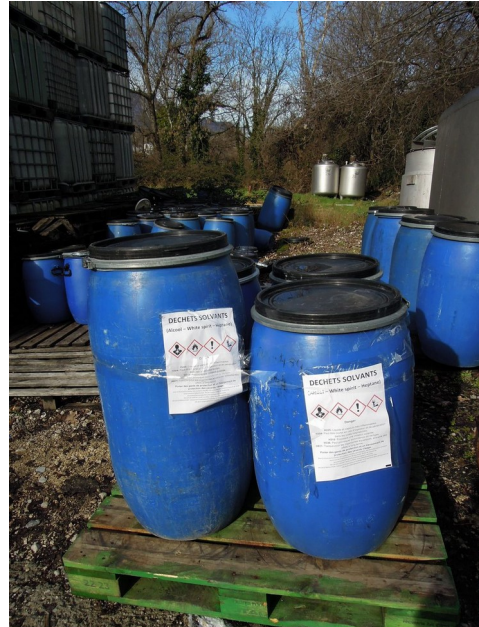
Stockage de 4 fûts pleins de déchets de solvants sans rétention à l'arrière du bâtiment Niveau rue - 2
