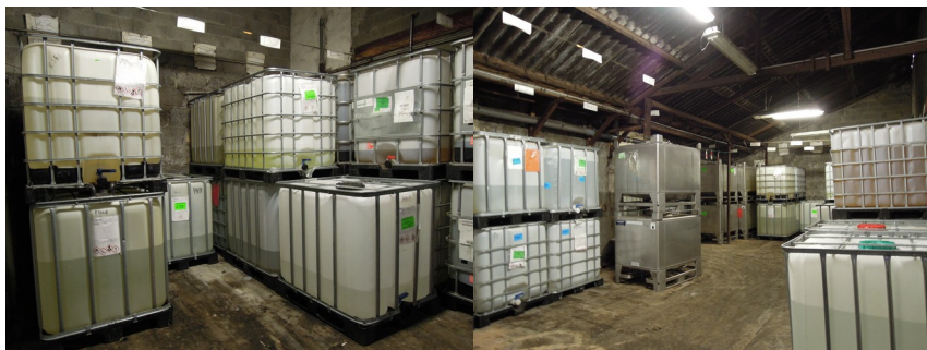
Stockages en contenants fusibles de liquides inflammables
