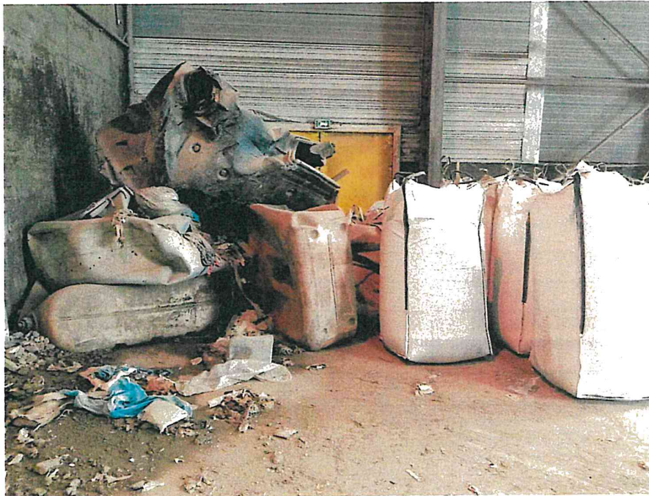
Photo 1 : accumulation désordonnée de gros déchets à proximité immédiate des big-bags non identifiés (REFIOM)
