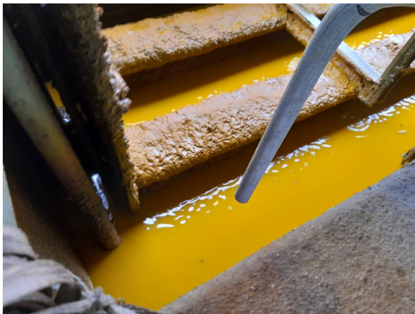
Arrivée d'eau potable pour la dilution du produit de préservation du bois
