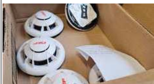
(stock des détecteurs optiques vu en visite)
