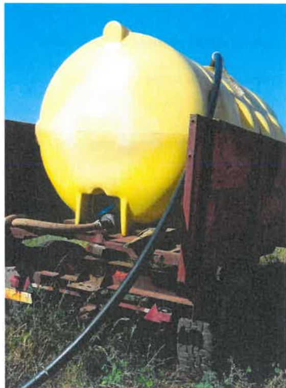
Citerne de stockage des effluents (dispositif provisoire)
